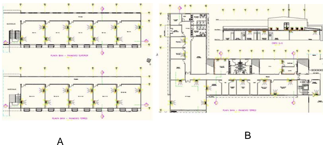
Figura 1. Planta baixa das salas do IFCE/Campus Crateús com os respectivos números de ar condicionados tipo split onde se localizarão o experimento. (A) planta baixa do bloco de ensino, (B) planta baixa do bloco administrativo.
